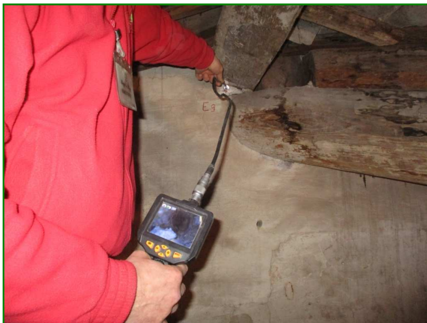
Esecuzione di indagine endoscopica
