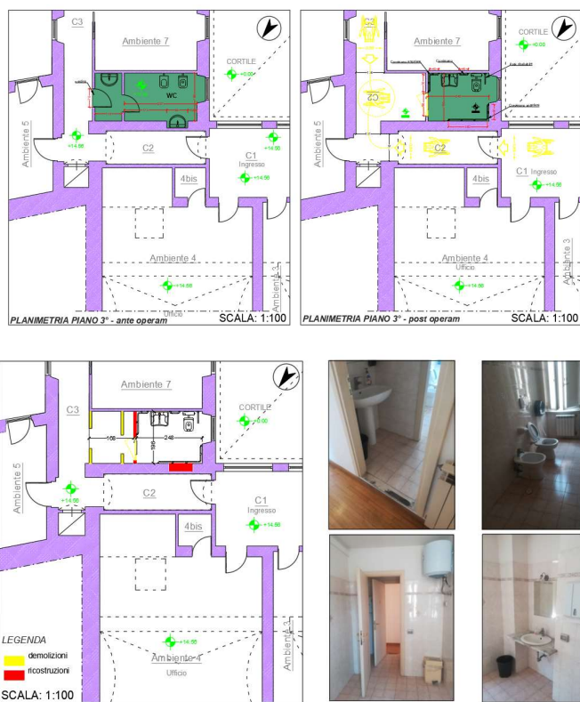
Fig. 19 – Piano terzo Palazzo Ossoli – interventi bagno disabili
