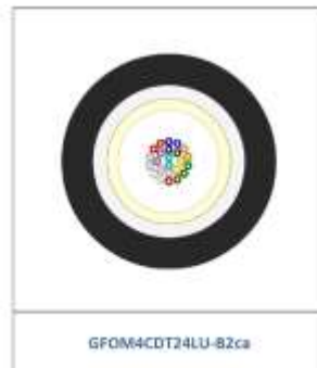
Cavo in fibra ottica di tipo dry loose (codice GFxxCDTyyLU-B2ca)
